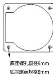
图三、图四: 底座安装尺寸图
